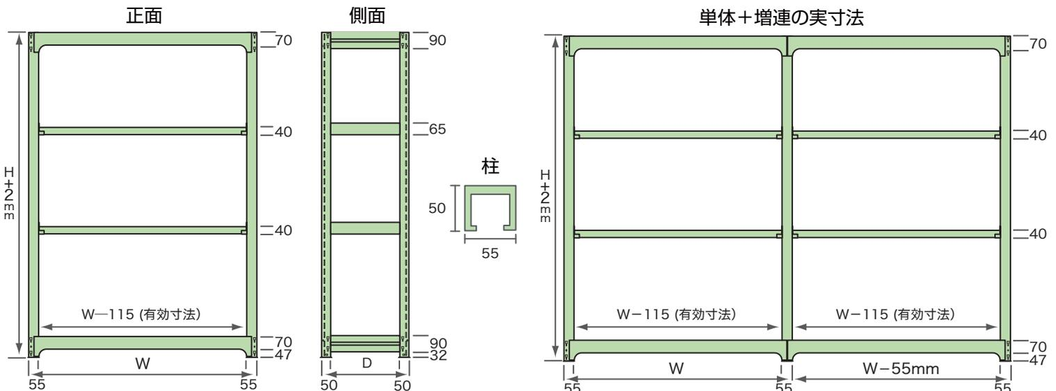
・本体外寸は、H+2、Wは寸法どおりでDは棚板が割板仕様となり、外寸が異なります。・棚板積載面有効寸法はW-115、D-40です。
