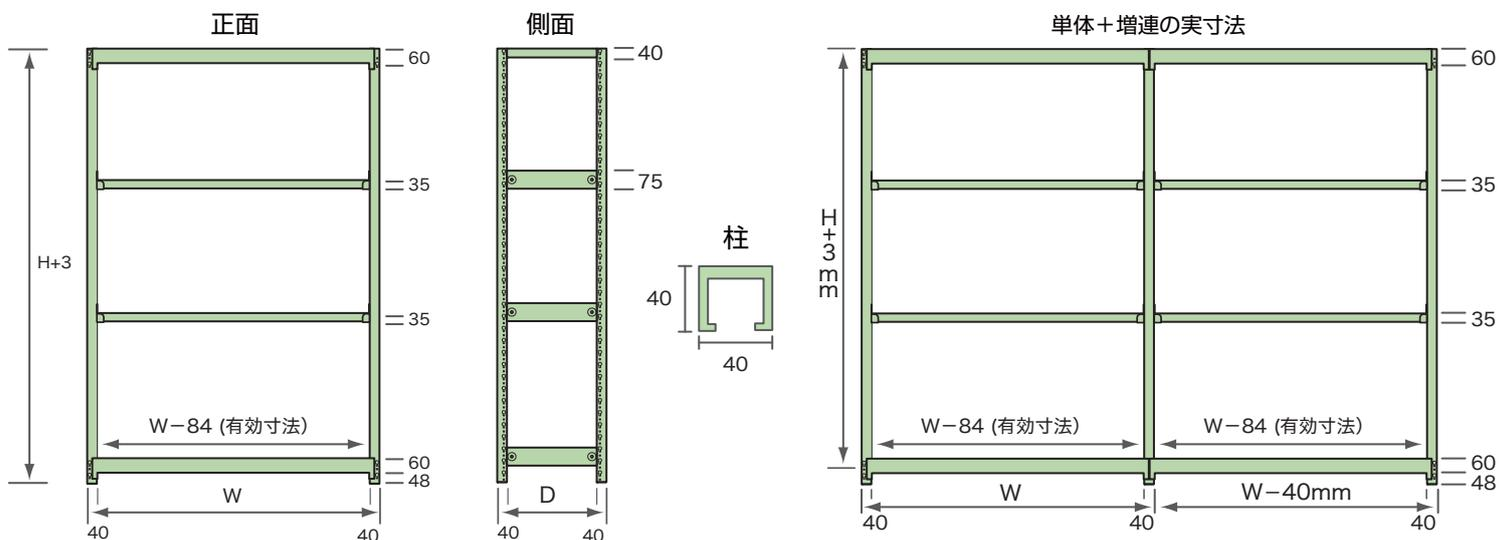
・本体外寸は、 $H+3$ 、 $W$ 、 $D$ は寸法どおりです。 ・棚板積載面有効寸法は $W-84$ 、 $D-27$ です。 ・耐荷重は、1段あたりの均等静止荷重を表します。
