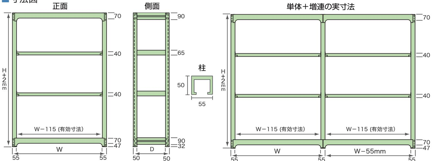
・本体外寸は、H+2、Wは寸法どおりでDは棚板が割板仕様となり、外寸が異なります。 ・棚板横載面有効寸法はW-115、D-40です。
