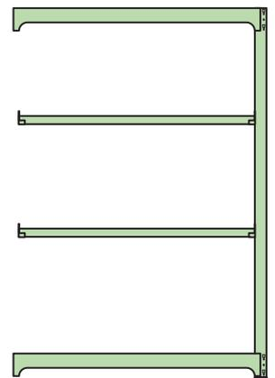
高さ・奥行が同じであれば支柱を共有し、側面同士を連結することが可能です。(支柱2本分のコスト削減にもつながります)
