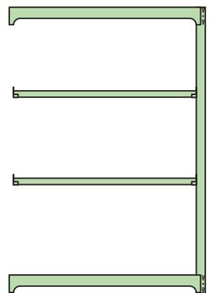
高さ・奥行が同じであれば支柱を共有し、側面同士を連結することが可能です。(支柱2本分のコスト削減にもつながります)
